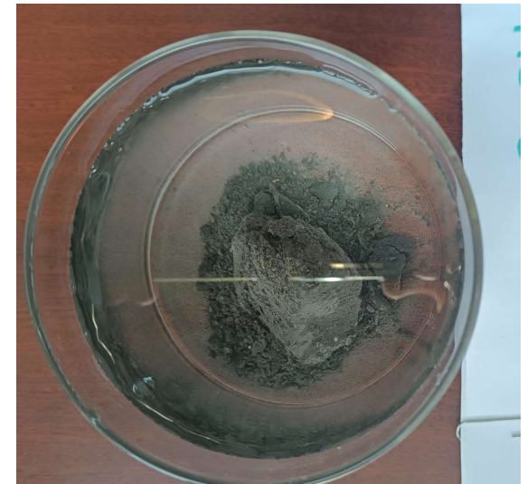
Échantillon après 24h de saturation
